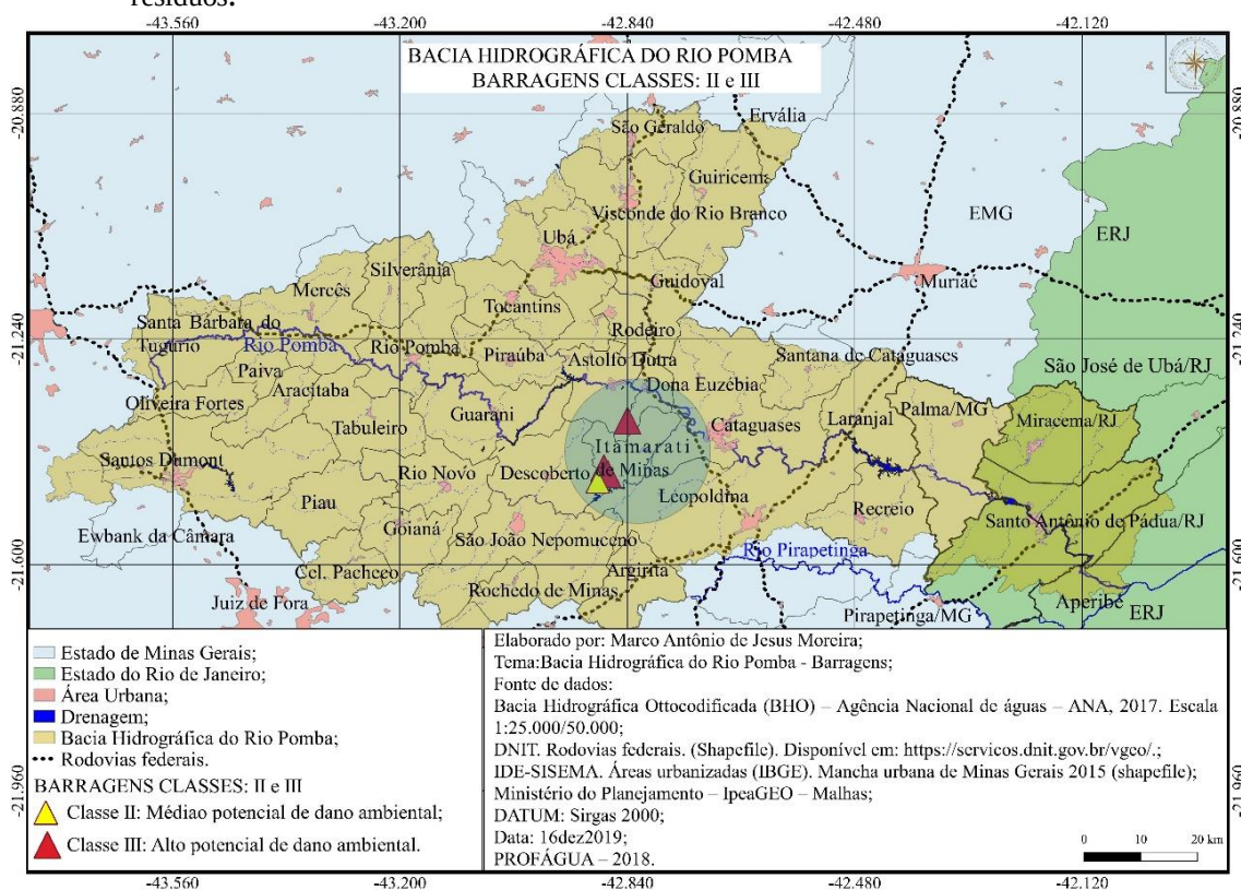
Figura 20 - Bacia Hidrográfica do Rio Pomba – Gestão de resíduos: Barragens de contenção de rejeitos e resíduos.
